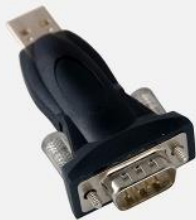
Beispiel eines USB-zu-Seriell Adapters
